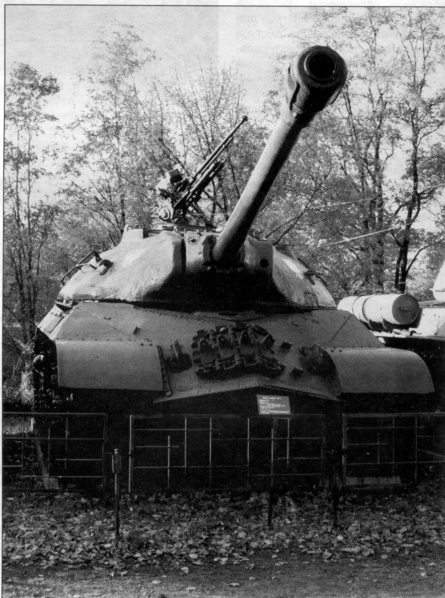
Танк ИС-3 в экспозиции Музея тяжёлого вооружения Войска Польского в Варшаве. На танк установлена 122-мм пушка Д-25Т с длиной ствола 48 калибров и с двухкамерным дульным тормозом
