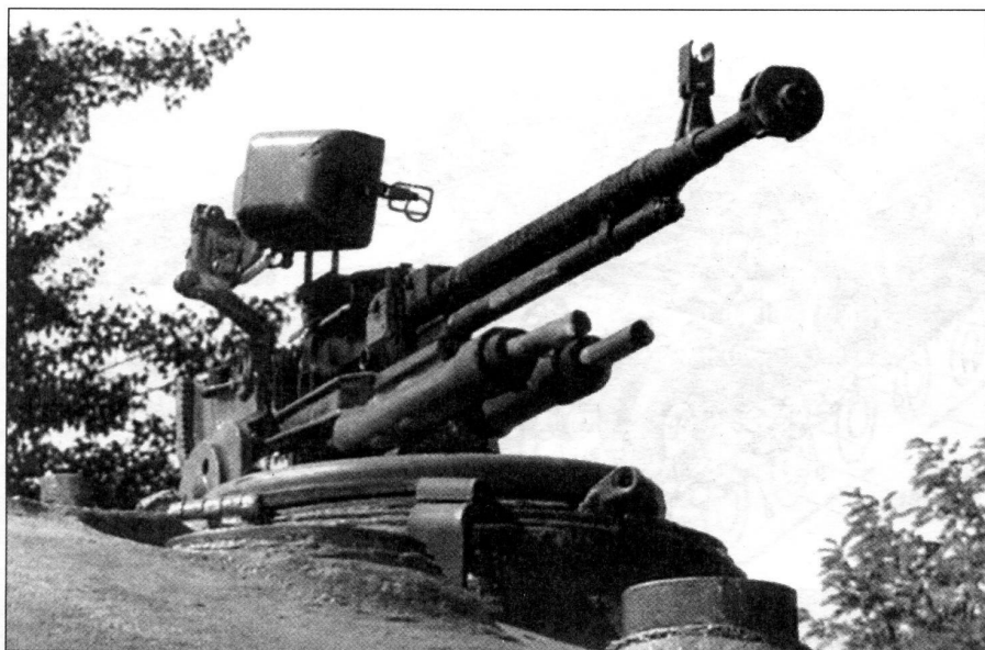
Крупнокалиберный 12,7-мм пулемёт ДШК (обр. 1938 г.) для поражения воздушных и наземных целей, установленный на крыше башни ИС-3
