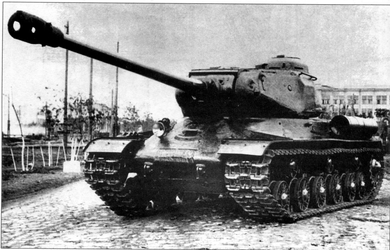
Тяжёлый танк ИС-2 со спрямлённым лобовым листом корпуса, установленным под углом 60°, что существенно повышало бронестойкость танка
